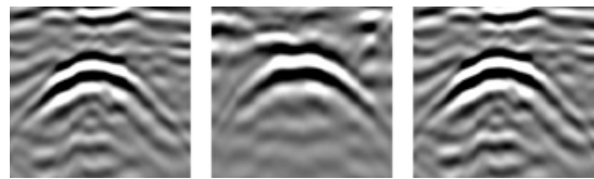
(그림 4) 배관이 존재하는 추출된 영상 (Figure 4) Extracted image with pipe
