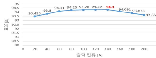
그림 4 정격 입력 전압시 LDC의 부하별 효율 그래프 Fig. 4 Efficiency Graph of LDC prototype when V_{in} = 650V
