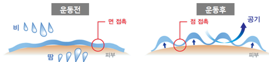
그림 1. 지능형 체온조절 섬유의 수분흡수에 따른 구조변화 모식도
