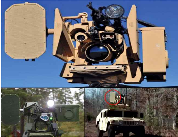
그림 3. RCWS와 연계한 확성기 운용 Figure 3. Loudspeaker Operations Integrated with RCWS
