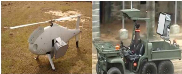
그림 4. UAV, UGV와 연계한 확성기 운용 Figure 4. Loudspeaker Operations Integrated with UAV/UGV
