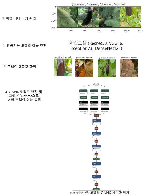
(그림 4) 가지 질병 분류 모델 구축 및 ONNX 변환 예시 (Figure 4) Example for creating a model of detecting eggplant disease and converting ONNX model
