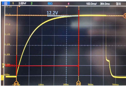
그림 7. 충전 시 커패시터 측정결과 Fig. 7. Capacitor measurement results during charging.
