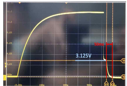
그림 9. 방전 시 커패시터 측정 결과 Fig. 9. Capacitor measurement results during discharge.
