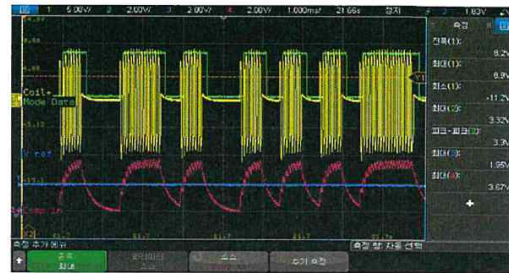
그림 12. 수신 코일 및 비교기 입출력 측정 Fig. 12. Receiver coil and comparator input/output measurement.
