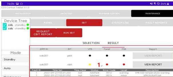
그림 13. BIT 제어 페이지 - BIT 결과 시현
