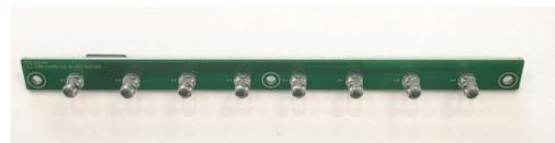
그림 4. UV LED PCB 구현
