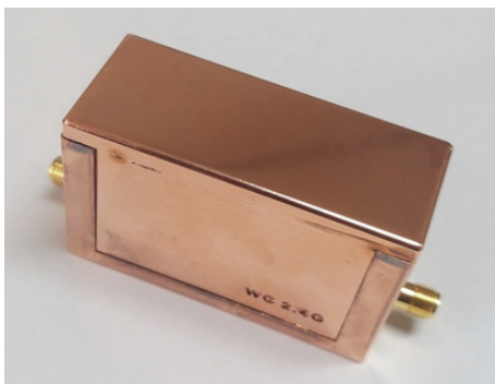
그림 6. 구리 도금된 도파관 필터의 사진
