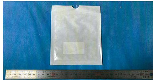
그림 1. 체외충격파치료기 리니어 프로브 카트리지 겔패드 인체접촉부 원재료[3, 4]
