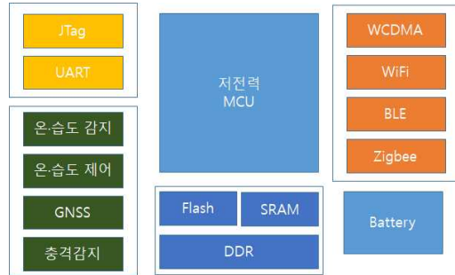
그림 8. 이동통신 장치(DUT)의 블록다이어그램 Fig. 8. Block diagram of mobile communication
