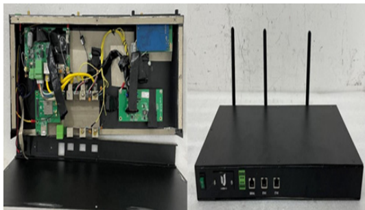
그림 2. VPN 모듈 내부 및 전면 사진 Fig. 2. VPN Module Interior and Front View
