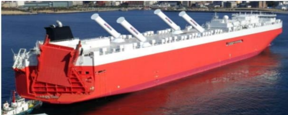
<그림 1 에너지효율 개선장치인 풍력추진 시스템 장착 선박 [1]>
