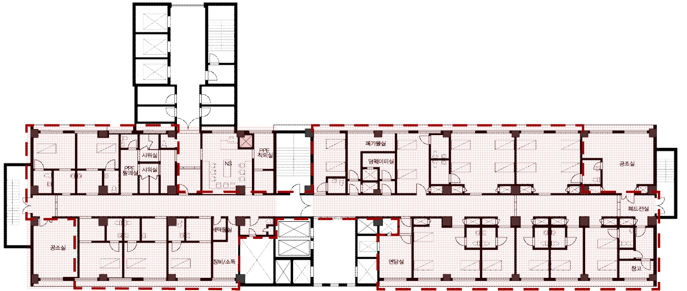
[그림 4] H병원 변경 후 도면(점선은 음압, 음영은 공사부분) 복도전실 음압, 계단실 아래 공사부분
