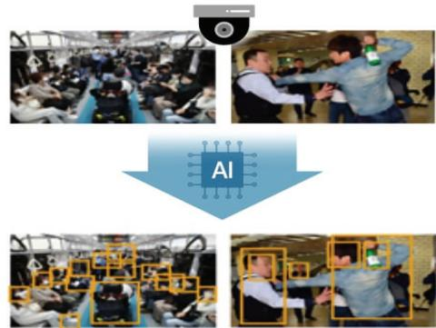
그림 4. AI기반 지하철 이상행동 감지 시스템
