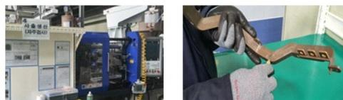
(c) Injection molding (d) Removing burr
