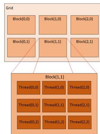
Fig. 10. GPU Architecture
