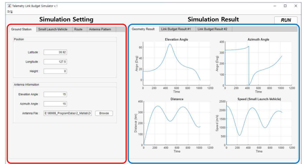
그림 10. 원격측정시스템 링크 버짓 시뮬레이터 실행 화면 Fig. 10. Telemetry link budget simulator
