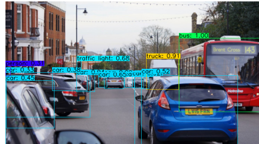
그림 3. 각 객체에 따른 바운딩 박스와 레이블 Fig. 3. Bounding boxes and labels according to each object
