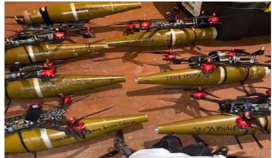
(그림 5) RPG-7탄두를 탑재한 FPV drone(15) (Figure 5) FPV drone with RPG-7 warhead(15)
