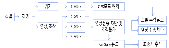
(그림 8) 자체제작 drone 제머 개념도 (Figure 8) Self-made drone jammer concept diagram
