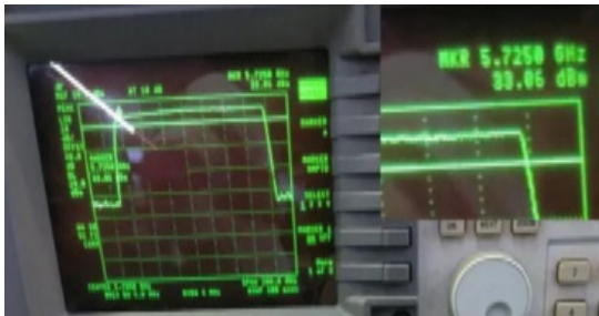
(그림 11) drone 재밍 5.8Ghz 모듈 테스트 화면 (Figure 11) drone jamming 5.8Ghz module test screen
