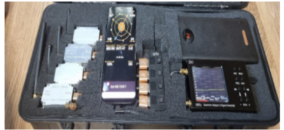
(그림 7) 자체제작 drone 제머 (Figure 7) Self-made drone jammer
