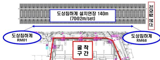
그림 2. 센서 설치 위치
