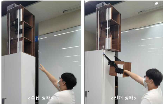
그림 8. 높이 조절 상부장 최종 형상 및 작동 과정 Figure 8. Final product and operation process of the height adjustable kitchen cabinet
