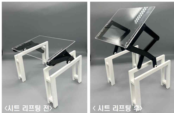
그림 8. 리프팅 시트 프로토타입 제작 형상 Figure 8. 3D printed prototype of the toilet lifting seat
