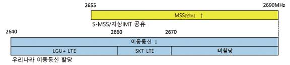
그림 3 2.6GHz 대역 MSS/지상IMT 간 주파수 분배현황
