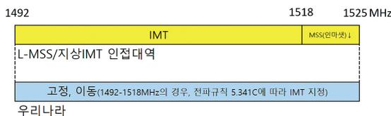
그림 1 L 대역 MSS/지상IMT 간 주파수 분배현황
