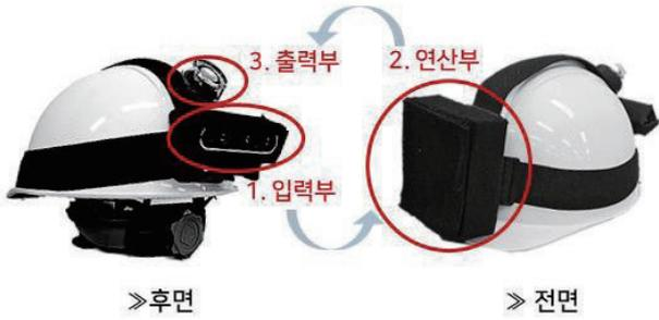
그림 4. 후방 위험물 감지 안전모 모델
