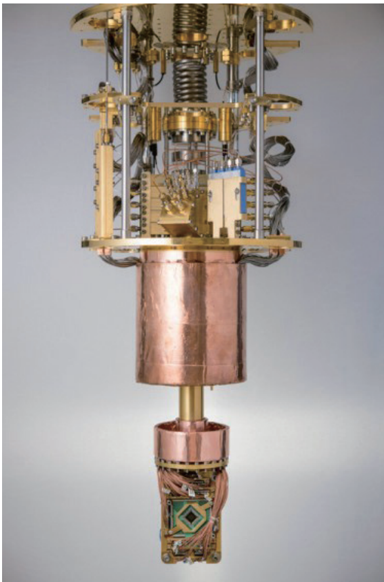
그림 3. 양자 컴퓨터용 사각형 모양의 프로세서로 프로세서가 정상적으로 작동하도록 초저온을 유지하는데 필요한 극저온 냉각 장치를 포함하고 있음 (출처: D-Wave).
