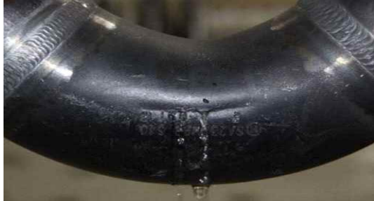
Figure 5. 피로균열 발생 배관
