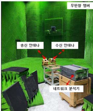
그림 8. 분리도 시험 셋업 Fig. 8. Test setup for isolation
