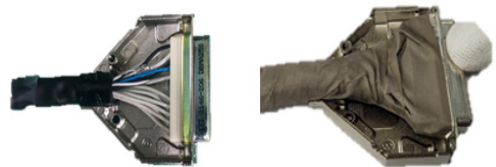
그림 10. 커넥터와 백셸 내부 차폐 Fig. 10. Shielding inside the connector and backshell
