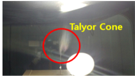
그림 4. 전기방사의 테일러콘 형성 Fig. 4. Taylor cone formation in electrospinning
