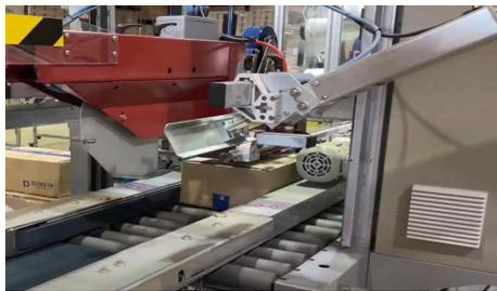
그림14. 실제 Box Taping 공정
