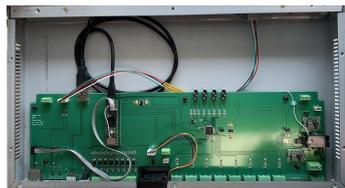
그림 6. UDP 수신기(Network D/A converter)
