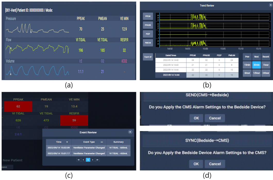
그림 2. 시스템 기능 (a) 호흡 파라미터 모니터링 (b) 데이터 트렌드 리뷰 (c) 이벤트 알람 리뷰 (d) 파라미터 알람 한도 원격 제어 Fig. 2. System Function (a) Respiratory Parameter Monitoring (b) Data Trend Review (c) Event Alarm Review (d) Parameter Alarm Limit Remote Control
