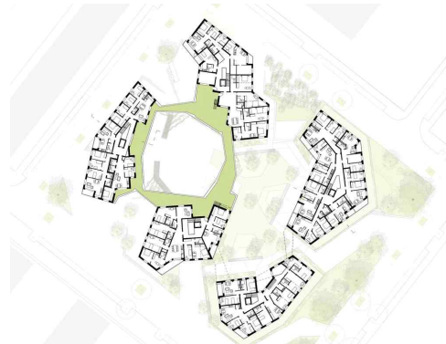
그림 5. 바그니스 아트 협동조합주택 주거단지 기준층평면도 Figure 5. Plan of Typical Plan of Wagnis ART Co-housing Complex[15]
