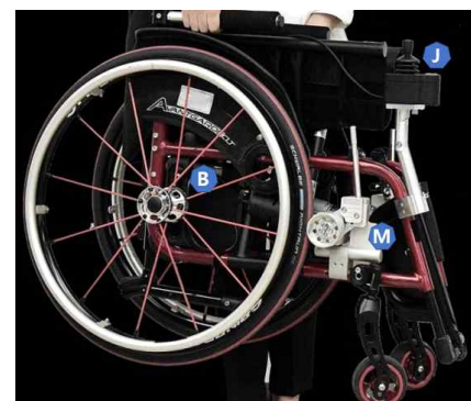
(B) 휠체어 프레임에 장착된 구동모터와 컨트롤러 J: joystick, M: drive motor, B: battery
