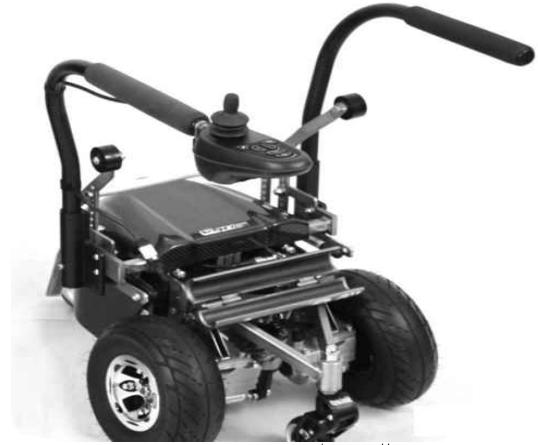
그림 2. 휠체어 하부 장착 동력보조 장치 Figure 2. Under-attaching power-assist wheelchair
