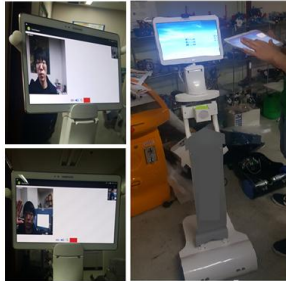
그림 14. 로봇에 장착 후 이미지 전송 실험 Fig. 14. Image transmission test after mounting on a robot
