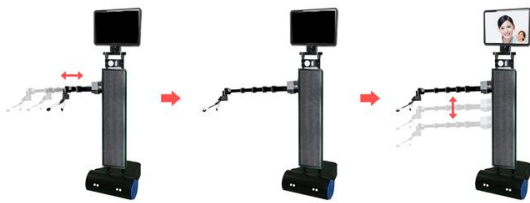
그림 4. 원격진료용 로봇팔 구조 Fig. 4. Robot arm structure for telemedicine
