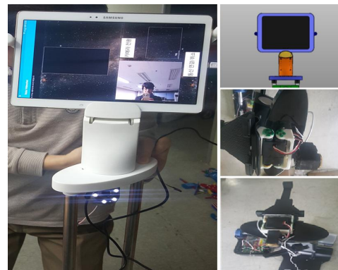
그림 8. 화상 통신용 모니터 유닛 Fig. 8. Monitor unit for video communication
