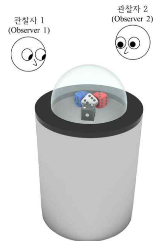
그림 1. 광학 모듈 어레이를 이용한 다시점 볼 렌즈 디스플레이의 개략도 Fig. 1. Schematic of the multi-view ball-lens display using optical module array
