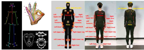
그림 3. 오픈포즈에서 특징점 추적[1], [4] Figure 3. Keypoints tracking in the OpenPose[1], [4]
