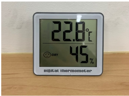
Fig. 1. Humidity meter(JB-913, Lklab, Korea).
