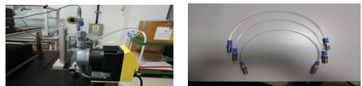
그림 6. 유량 펌프 및 유속 변경용 튜브 Fig. 6 Tubing for flow pump and flow rate change
