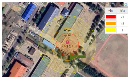
(그림 10) 영내 수소충전소 적용 (Figure 10) Application of In-site Hydrogen Charging Station
