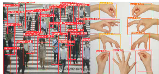
(그림 1) YOLO를 이용한 다중 객체 탐지 (Figure 1) Multiple object detection using YOLO
