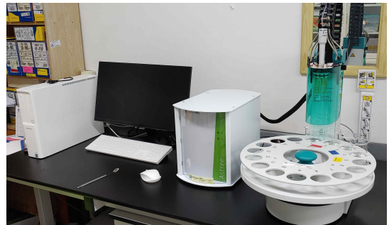
그림 1. 본 연구에 사용된 Astree E-Tongue Figure 1. Astree E-Tongue used in this Research
