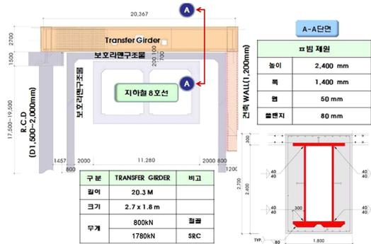
그림 1. 트랜스퍼 거더 개요도[1]
