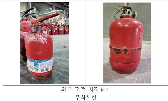
그림 2. 분말소화기의 저장용기 부식 상태
