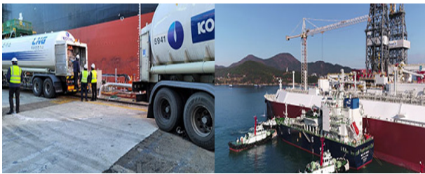
Fig. 2 Example TTS & STS LNG bunkering (KOLB, 2022)
