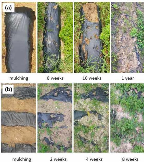
그림 1. 멀칭기간에 따른 멀칭필름의 외관변화 : (a) PBAT (HF02) 필름 (b) 비교예(control TPS 10wt%)
