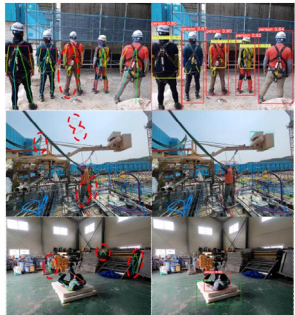
그림 7. 부적절한 근로자 탐지 및 자세 추정 결과(건설 현장 및 AI 허브 영상)
