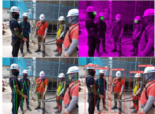
그림 6. 적절한 근로자 탐지 및 자세 추정 결과(건설 현장 영상)
