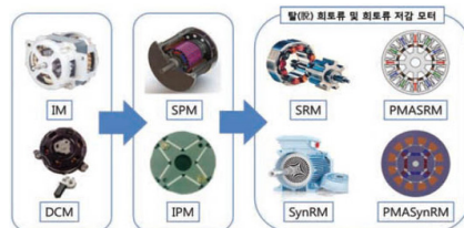
그림 7. 견인 구동용 전동기의 개발 방향 Fig. 7. Development direction of electric motor for traction drive
